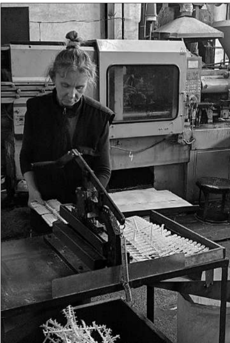
Ливарник пластмас Валентина Соболь обрізає литники на прищіпці, яку вливають на термопласт-автоматах.
